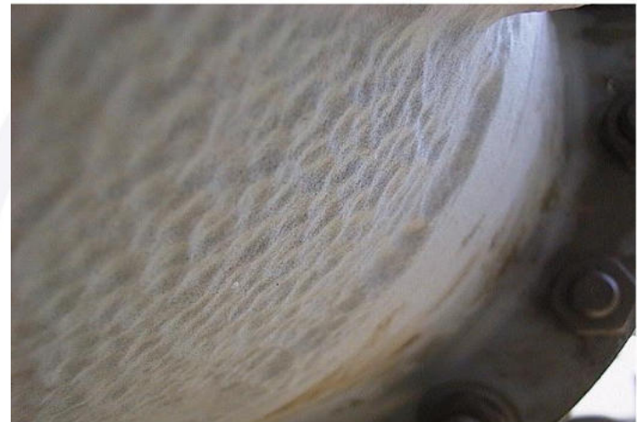
027 E-47 Particolare della corrosione esterna sulla superficie del mante
