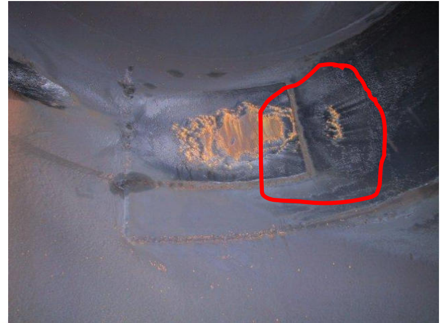
Erosioni su doppia piastra di sacrificio metallica
